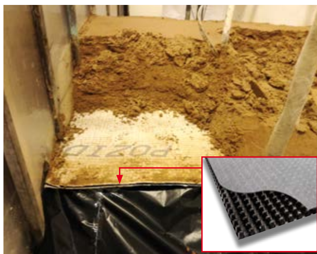
FOT. 1. Geokompozyt drenażowy z strukturą przestrzenną w formie wytłaczanego rdzenia; fot.: archiwa autorów
